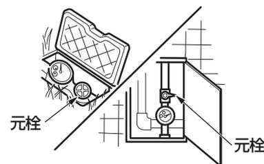
マイナスドライバーなどで湯側・水側の止水栓を閉める。
