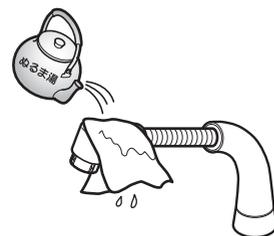
水抜きを行っても吐水口の網目やフィルターに付着した水滴が凍り、通水後も少しの間、水が出ない場合があります。そのときはハンドシャワーを引き出し、タオルなどの布を巻き付け、しみこませるようにゆっくりとぬるま湯をかけてください。
