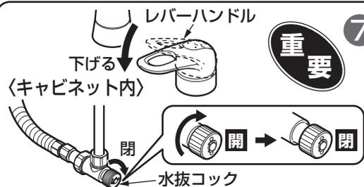
⑦水が抜けたら、ハンドシャワーを元に戻し、レバーハンドルを下げて、水抜コックを閉める。
