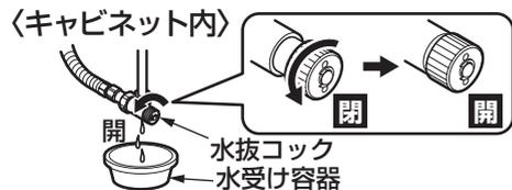
④水抜コックの下に水受け容器（洗面器など）を用意し、水抜コックを開ける。
