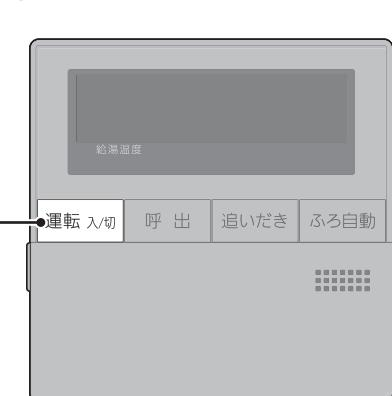
優先表示が点灯すると、台所リモコンで記憶していた給湯温度を表示し、お湯の温度が調節できます
