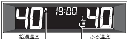
たし湯の燃焼中 点灯 矢印が動きます
